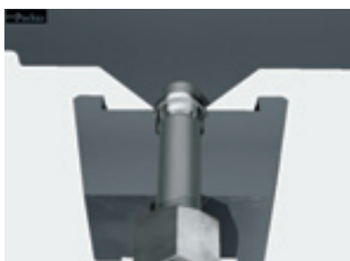
Труба вставляется в инструмент до упора
